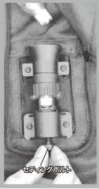
5.六角レンチでキーボールの穴が中心にくるよう調節します(写真5)
