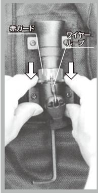
8.セッティングボルトを外します(写真8)
