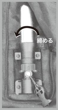
注意 ⚠ カートリッジポンベのねじ込みが緩いと、エアバッグ作動の際に膨らみが弱くなるなどの誤作動の原因になります
