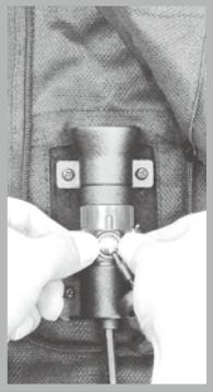
7.赤ガード(スライドカバー)でキーボールが正しくセットされたかを確認します(写真7)
