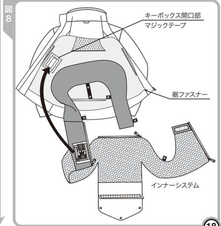
2. 気室側のキーボックス部を、ウェア右側のキーボックス開口部に、四方のマジックテープを合わせて取り付けます。(図8)
