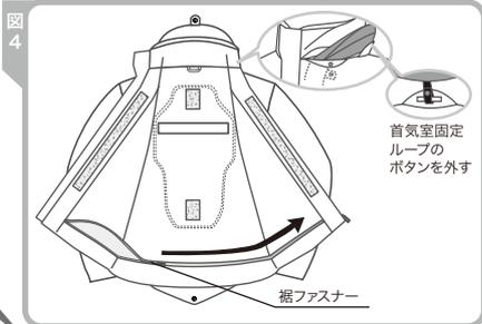
エアバッグシステムは、ウェア内部に、ウェアと気室を3カ所のファスナーで接合し固定しています。キーボックス部左胸(A)、背中(B)、右胸(C)
