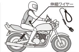
取付け位置 A: シートを外し 内部フレーム部分
